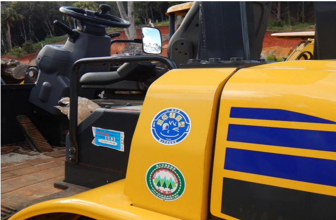
低騒音・排出ガス対策型建設機械を使用し、騒音や排出ガスの抑制を行い希少動植物に配慮している。
